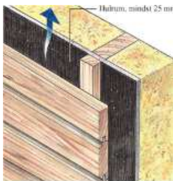
Figur 3: Min. 25 mm ventileret hulrum (Træinformation, Træ 55)
