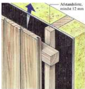
Figur 2: Min. 12 mm ventileret hulrum (Træinformation, Træ 55).
